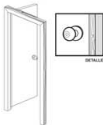
2 ARMADO DE PUERTA, MARCO Y CHAPA
