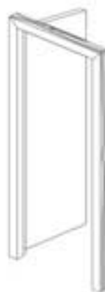
3 ARMADO DE PUERTA AL MARCO
